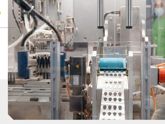
Le provette riempite vengono sigillate, ed eseguiti test di tenuta della chiusura in base alle specifiche richieste del cliente.
